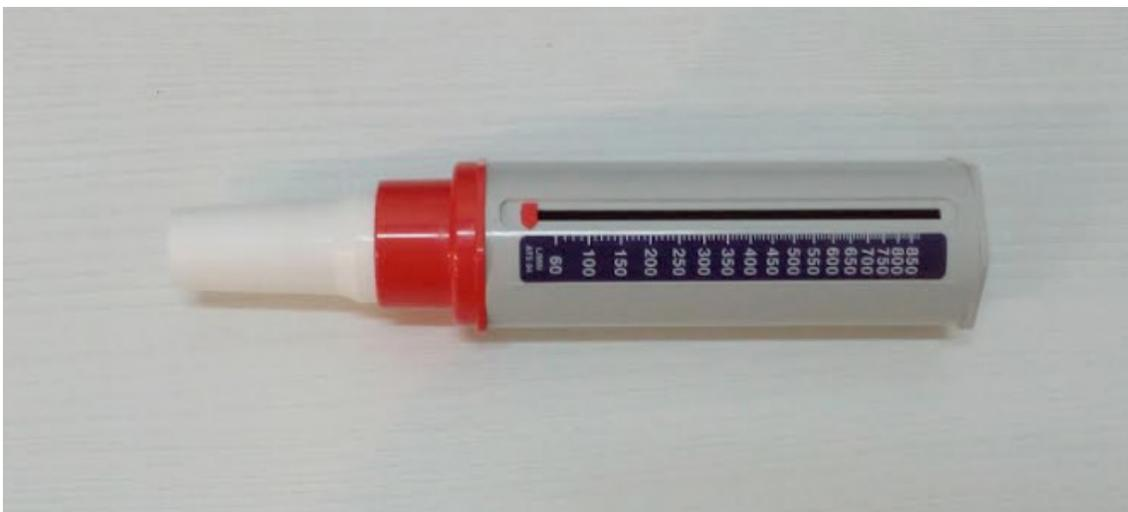
Figura 1. Flujómetro *Mini-Wright*.
